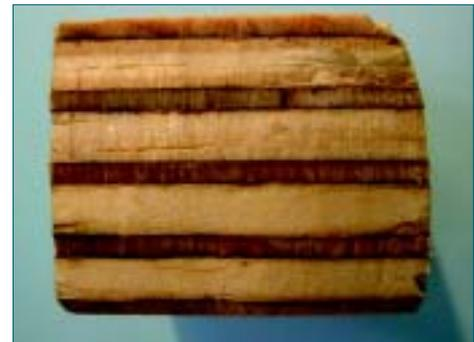
Fig 1.1 - Compensado de madeira com várias camadas de madeira laminada colada e com orientação do veio cruzada em cada camada.
